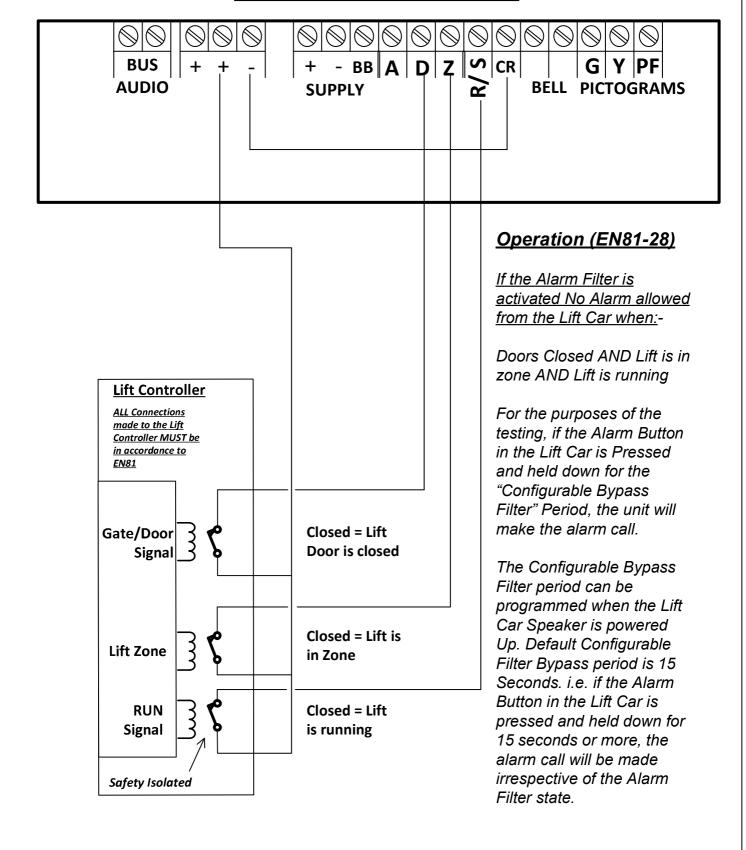
**Alarm Filter Wiring**
